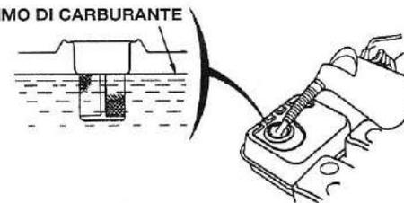
Eseguire le operazioni di rifornimento in un'area ben ventilata prima di avviare il motore. Se il motore è stato in funzione, lasciarlo raffreddare. Effettuare il rifornimento con cura, per evitare fuoriuscite di carburante. Non riempire oltre i limiti del filtro. Dopo il rifornimento, serrare saldamente il tappo del serbatoio.
